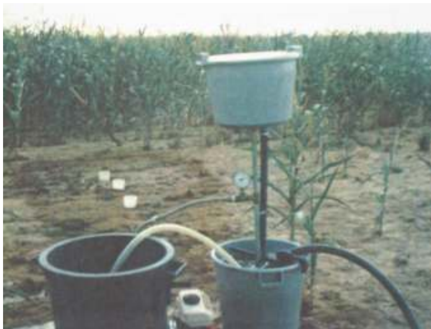
Figura 13 - Realização de um teste de infiltração.
