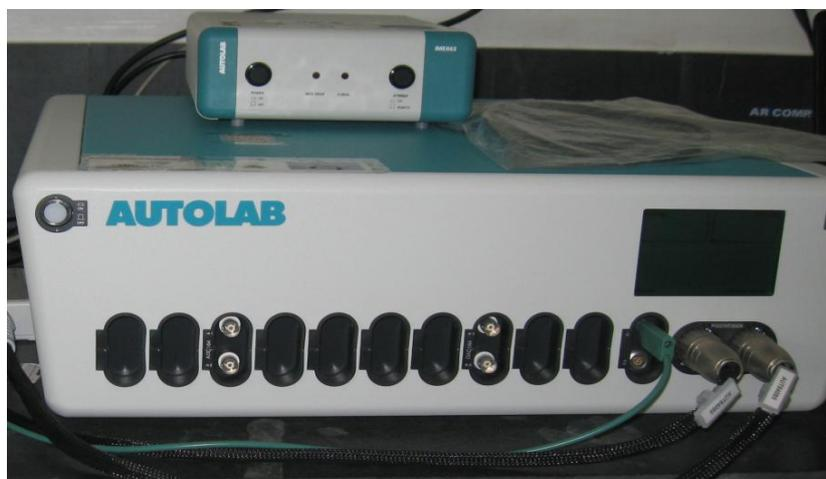
**Figura 2.1-** Potencióstato/Galvanóstato AUTOLAB PGSTAT302N (em baixo) e a interface eletrónica IME663 (em cima).
