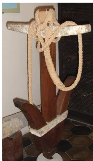
Fig.47 – Réplica de âncora de madeira com aplicação de cepo de âncora em chumbo. (Museu de Albenga, Itália)
