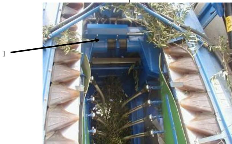
**1 – Cilindro hidráulico para regular folga entre os corpos da máquina de vindimar
