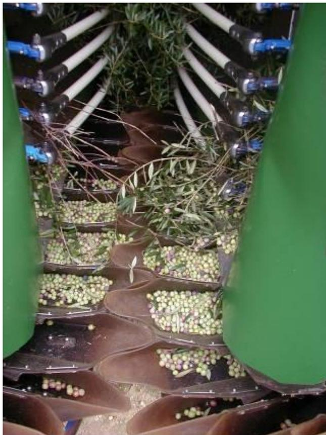
**Fig. 1.21 - Transportador contínuo de godés deformáveis
