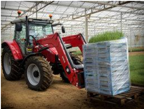
Regulação para “suave” para evitar queda da carga.
