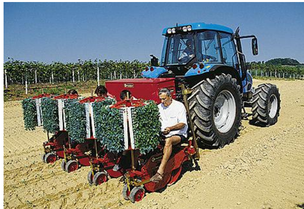
Plantador: exemplo de trabalho que requer velocidades super-lentas
