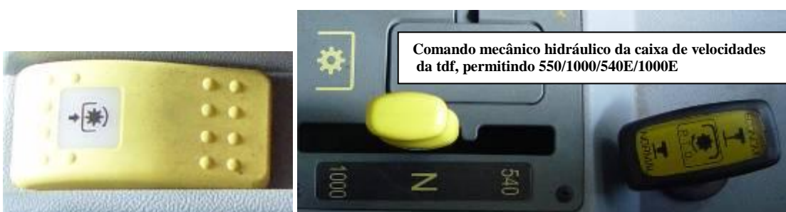
Comando eléctrico hidráulico da embraiagem da tdf
