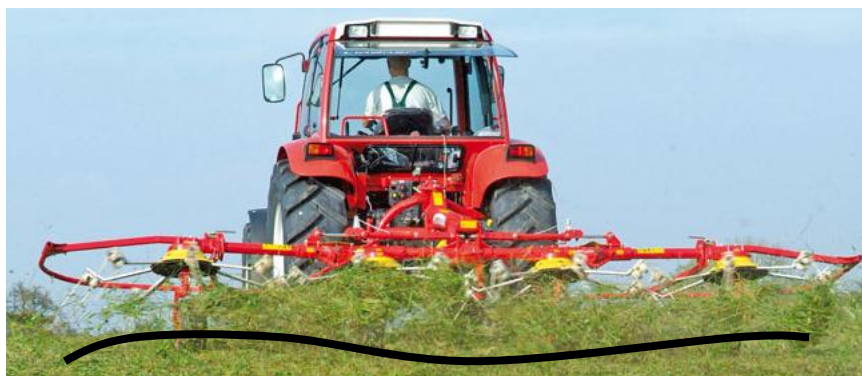
Os cilindros hidráulicos deverão estar ligados a válvula do SESH com flutuação
