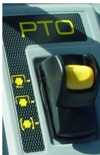
Comando eléctrico hidráulico da embraiagem da tdf
