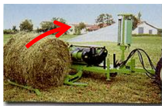
Braço de carga do fardo para a mesa rotativa www.mchale.net
