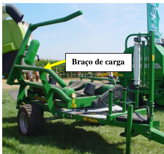
Braço de carga do fardo para a mesa rotativa www.mchale.net
