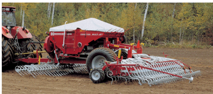
Semeador de fluxo contínuo com distribuição de semente em fluxo de ar
