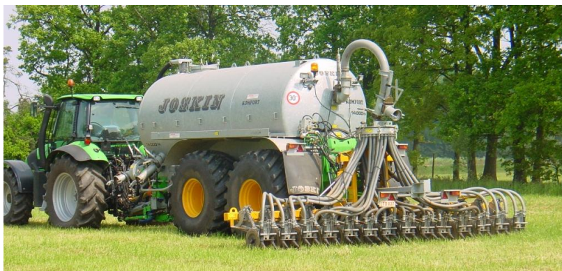
Semi-reboque para distribuir e enterrar estrumes líquidos www.tanlake.co.uk
