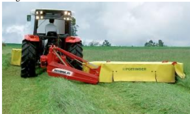
Gadanheira de discos ( disc mower ) http://www.poettinger.at/en/landtechnik/
