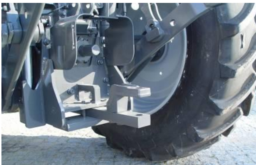
Barra de puxo no tractor Massey Ferguson 5465 usado no curso 2009/2010
