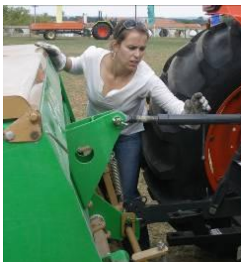
Acerto da inclinação da alfaia no 3º ponto (RURALTEC 2006 - Mitra)
