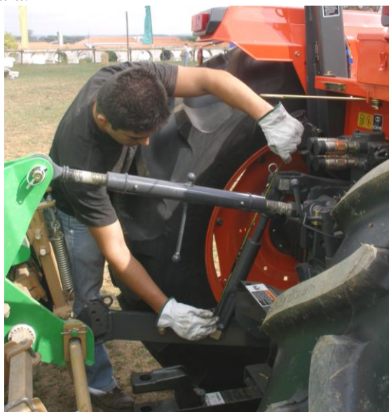
Medição do comprimento do pendural esquerdo (RURALTEC 2006 - Mitra)
