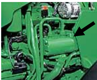
Bomba de óleo do sistema hidráulico do tractor situada na parte lateral do motor Diesel
