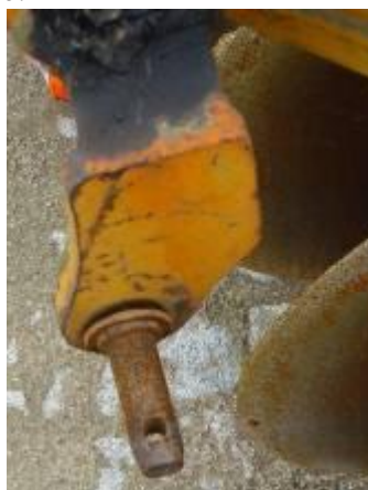
Exemplo de um munhão de cabeçote de alfaia
