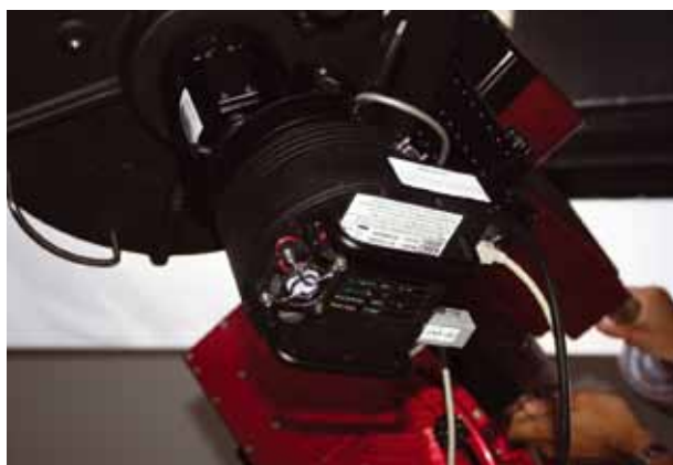
Fig. 3 - Sensor CCD utilizado na obtenção de dados de trânsitos planetários.
