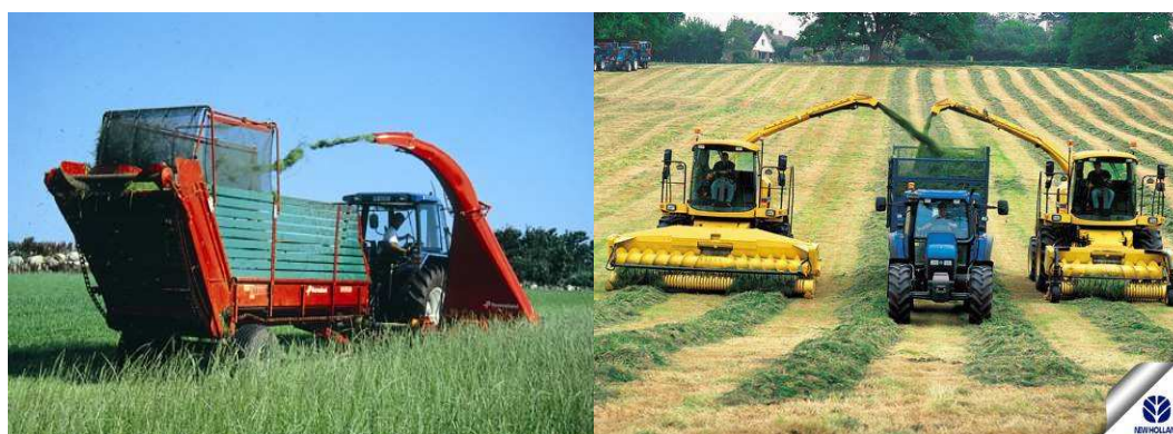
Fig. 18. Ensiladoras ou colhedores de forragem
