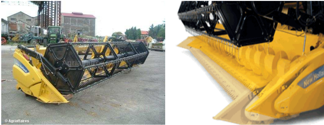
Fig. 5. Barra de corte para cereais de outono-inverno e de algumas culturas de primavera-verão como por exemplo, o girassol (New Holland)
