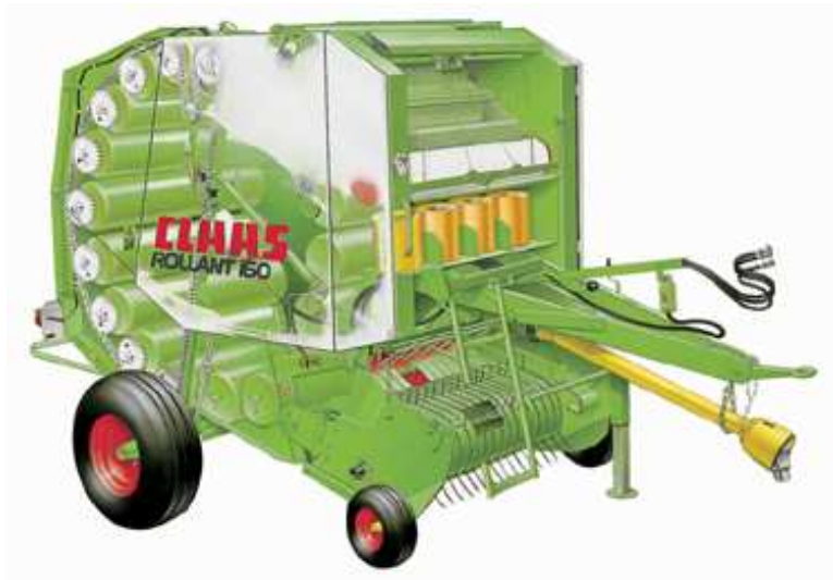
Fig. 25. Esquema de uma enfardadeira de fardos cilíndricos (Claas)
