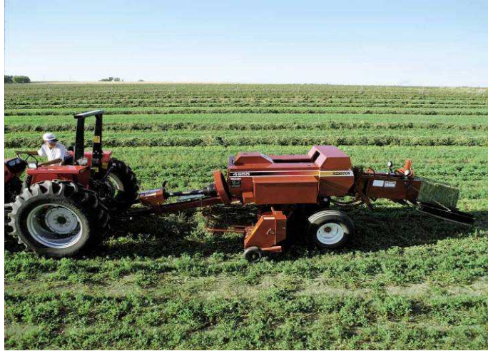
Figura 21. Enfardadeira de fardos paralelepípedicos de média pressão a enfardar feno (New Holland)
