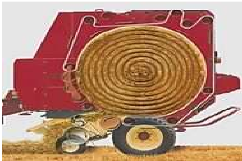
Fig. 26. Enrolamento do fardo numa enfardadeira de fardos cilíndricos
