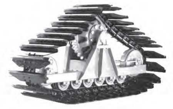
Fig. 10. Sistema de lagartas ou de rasto contínuo (Carvalho & Saruga, 2007)
