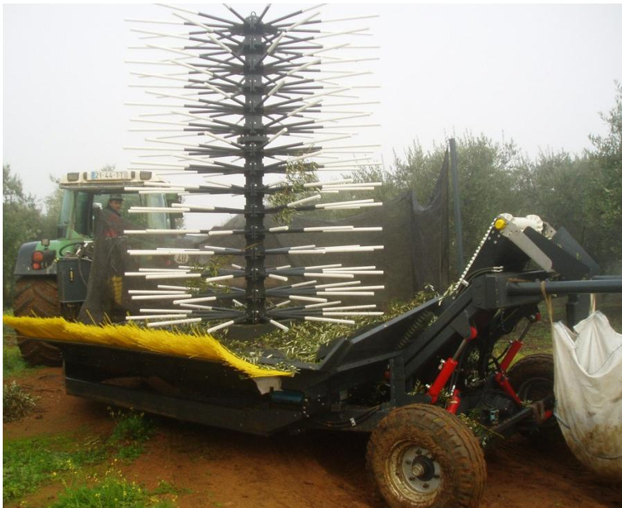
Figura 1 – Aspecto geral da Máquina de Colheita em Contínuo de Azeitona
