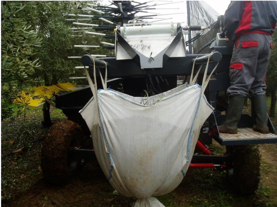
Figura 6 – Sistema de armazenamento temporário de azeitona
