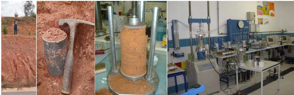
Figura 1. Colheita de amostra (A), processo de constituição de provetes (B) e equipamento triaxial utilizado (C).
