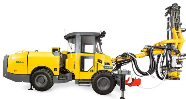
Figura 4.5 - Jumbo de furação e colocação de parafusos Boltec, da marca Epiroc (adaptado de Epiroc, 2025).
