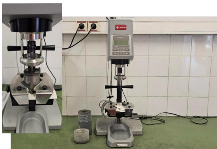
Figura 5.23 - Imagem do reómetro digital (RheolabQC) onde é determinada a reologia da pasta.
