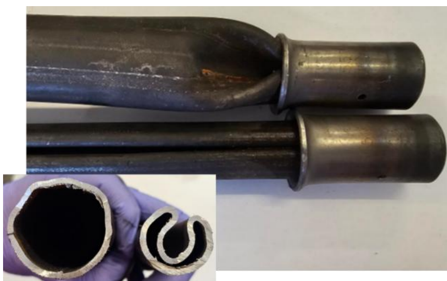
Figura 5.2 - Imagem de parafusos expansivos onde é possível verificar a diferença de perfil entre um parafuso antes e depois de ser expandido.
