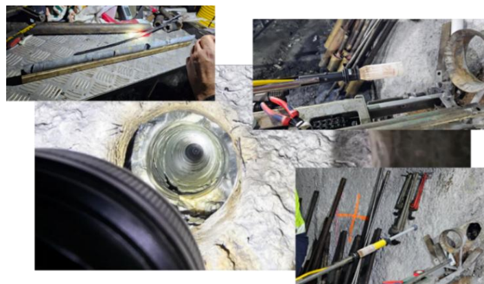
Figura 5.28 - Imagem do comprimento final do furo, com pormenor do testemunho de pequeno diâmetro e célula de medição acoplada na vara de colocação.
