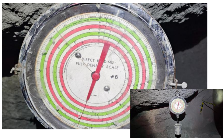
Figura 5.9 - Imagem da escala da balança de Marcy e pormenor do conjunto, balança e copo de medição.
