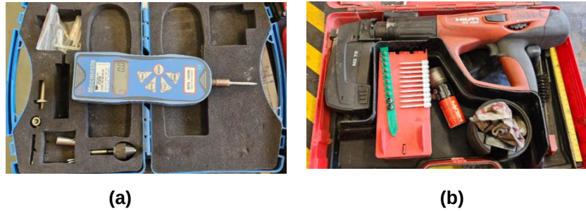
Figura 5.19 - a) Imagem do penetrômetro digital utilizado na primeira fase do ensaio de verificação das resistências iniciais. b) Imagem da pistola Hilti, fulminantes verdes e pregos de 52 mm utilizados na segunda fase do ensaio de verificação das resistências iniciais.
