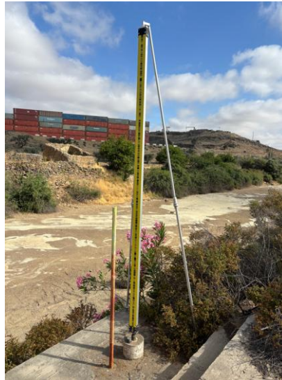
Figura 5.38 - Imagem de subsidência e mira de invar, captada durante a leitura.
