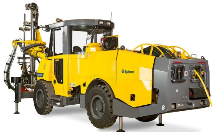
Figura 4.1 - Jumbo de sustimento da marca Epiroc para parafusos expansivos (adaptado de Epiroc, 2025).
