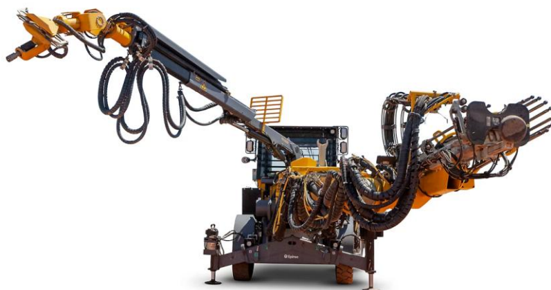
Figura 4.8 - Jumbo de sustimento Boltec para parafusos autoperfurantes da Epiroc (adaptado de Epiroc, 2025).
