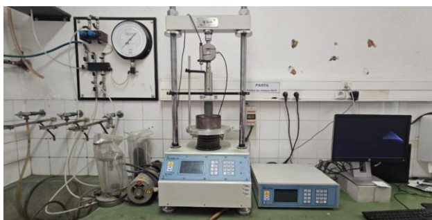
Figura 5.26 - Imagem da prensa hidráulica (VJ Tech) para ensaios RCU de Pasta.
