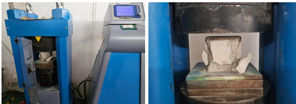
Figura 5.11 - Imagem da prensa hidráulica MATEST utilizada para realizar os ensaios RCU.
