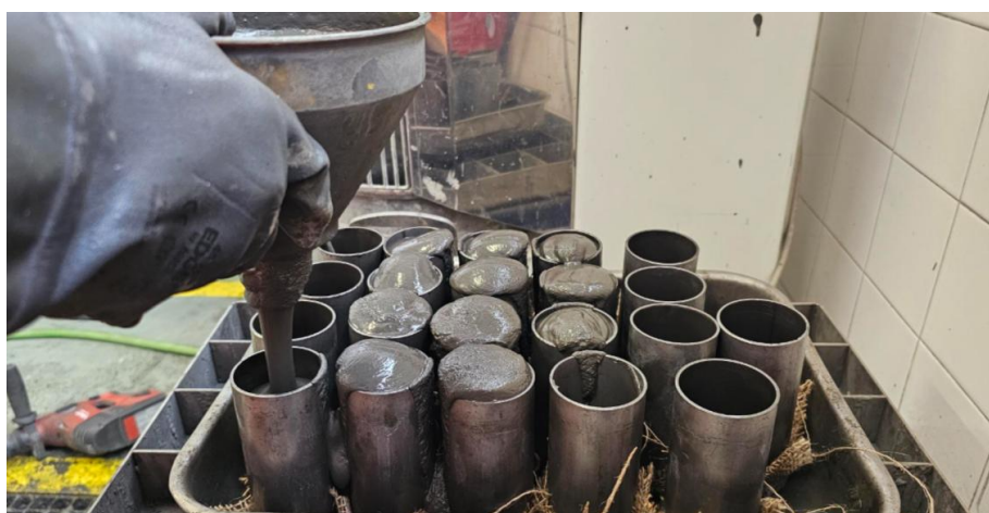
Figura 5.24 - Imagem de execução de provetes de pasta para posterior realização de ensaios RCU.
