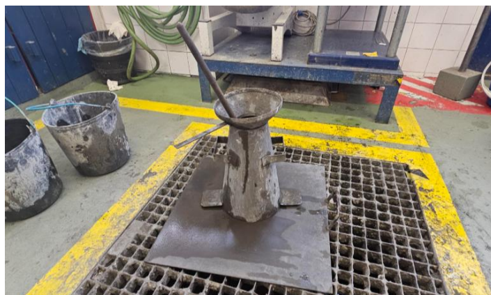
Figura 5.16 - Imagem de equipamento para ensaio de abaixamento ( slump test ) composto por chapa, cone, funil e pilão de compactação.
