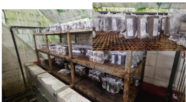
Figura 5.25 - Imagem da câmara de cura e pormenor da identificação dos provete.
