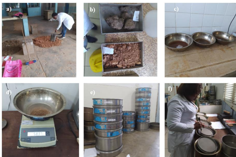
Figura 2.2: Realização dos ensaios de laboratório no LEM. a) Preparação da amostra para o ensaio. b) Secagem das amostras na estufa a uma temperatura de 110 °C durante 24 horas. c) Imersão das amostras na água durante 24 horas. c) Pesagem das amostras após a lavagem e secagem na estufa. d) Série de peneiros utilizados para a peneiração das amostras de solo. f) Processo de separação do material retido nos peneiros para posterior pesagem.
