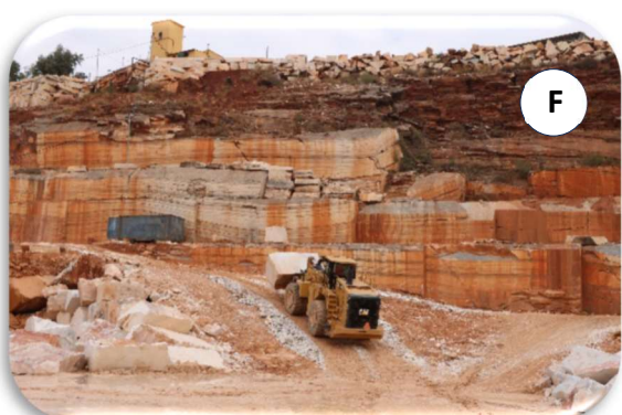
Figura 7 – Ciclo de trabalhos realizados na Pedreira Texugo Nº 3: (A) perfuração por rotopercussão; (B) corte vertical com fio diamantado; (C) tombamento com recurso a equipamento “tomba-bancadas hidráulico” (patenteado pela empresa portuguesa, Fravizel, S.A.); (D) talhada desmontada; (E) esquadrejamento da talhada; e (F) remoção de material para a superfície.
