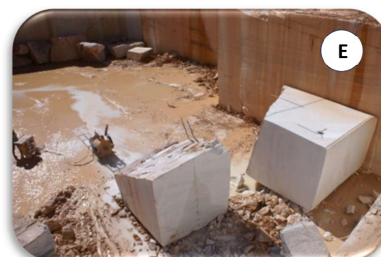
Figura 7 – Ciclo de trabalhos realizados na Pedreira Texugo Nº 3: (A) perfuração por rotopercussão; (B) corte vertical com fio diamantado; (C) tombamento com recurso a equipamento “tomba-bancadas hidráulico” (patenteado pela empresa portuguesa, Fravizel, S.A.); (D) talhada desmontada; (E) esquadrejamento da talhada; e (F) remoção de material para a superfície.
