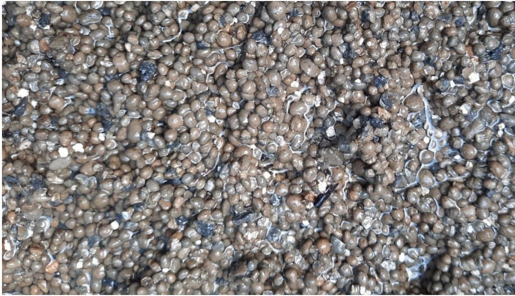
Figura 3.1 Mistura de LECA 2/4 e vermiculite 2 (1:1, v/v)
