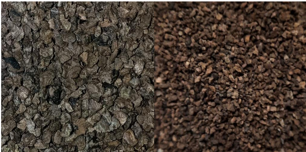
Figura 3.2 Cortiça 3/5 (à esquerda) e cortiça 0.5/3 (à direita)
