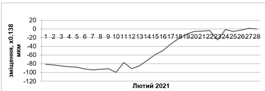
Рис. 3. Зміщення кори на ПДС «Королеве» в лютому 2021 року. Зона Оашського глибинного розлому
