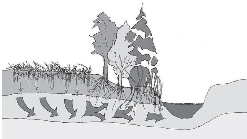
Fig. 3.11. Efeito de filtro e de extração exercido pela vegetação ripícola sobre as substâncias químicas dissolvidas nos fluxos sub-superficiais provenientes, por ex., de explorações agrícolas contíguas
