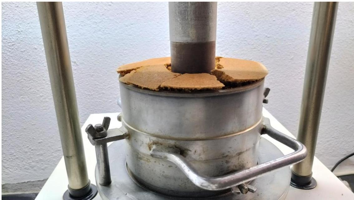
*Figura 57. Condição de um provete após atingir resistência máxima*
