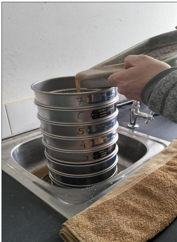
*Figura 15. Peneiração de solos por via húmida*
