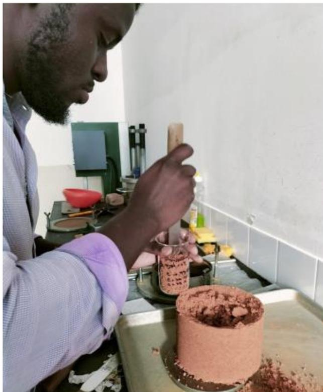
*Figura 30. Toma de porções do provete para a determinação do teor em água*
