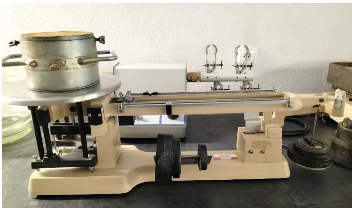
*Figura 28. Pesagem do molde contendo o provete*
