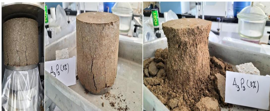
Figura 50. Condições de uma das amostras do conjunto A após carregamento
