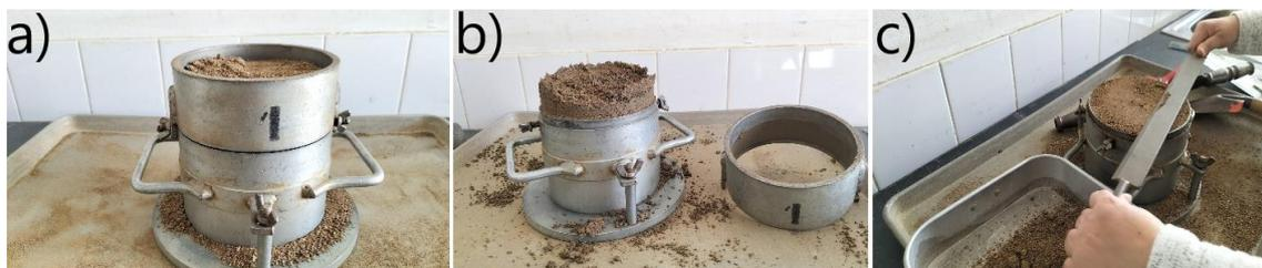
*Figura 27. Rasuramento do provete: a) transferência do molde com provete compactado; b) remoção da longa; c) processo de rasar o provete*
