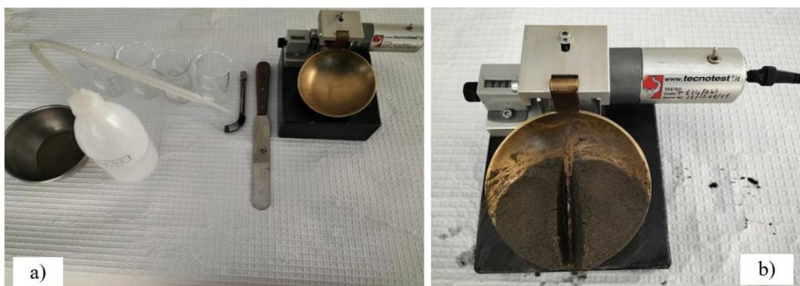
Figura 17. Determinação do limite de liquidez: a) – materiais necessários e b) – execução do ensaio
