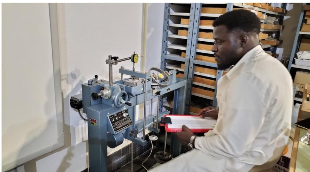
*Figura 40. Realização do ensaio de corte*
