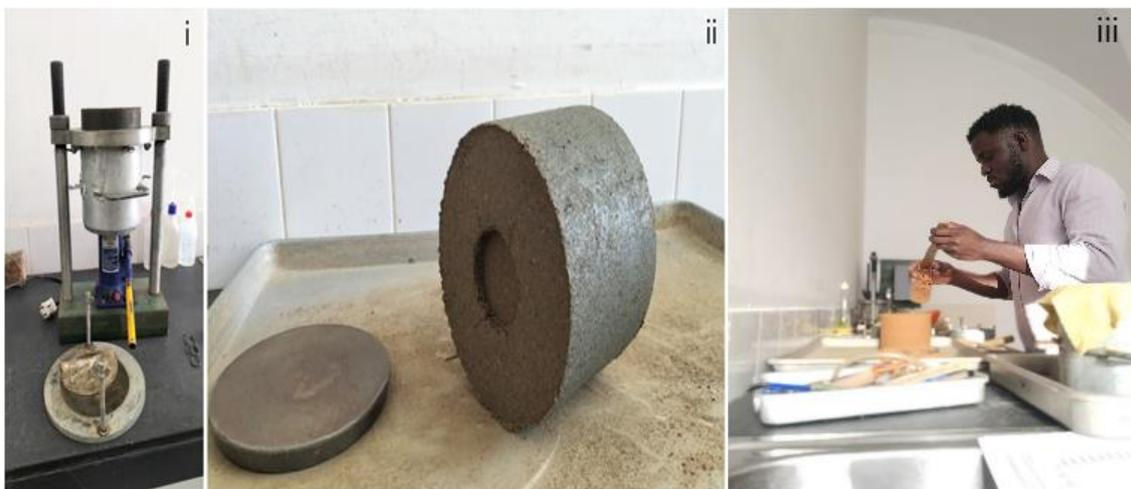
Figura 36. Extração e recolha de porções do provete para a determinação do teor em água
