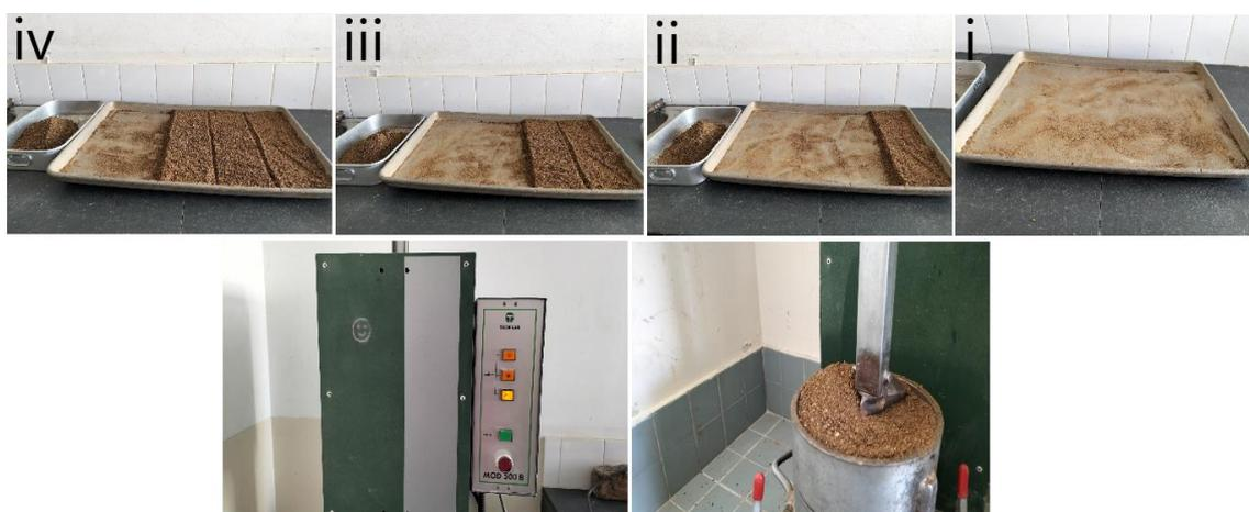
*Figura 26. Compactação das restantes quatro partes do provete*
