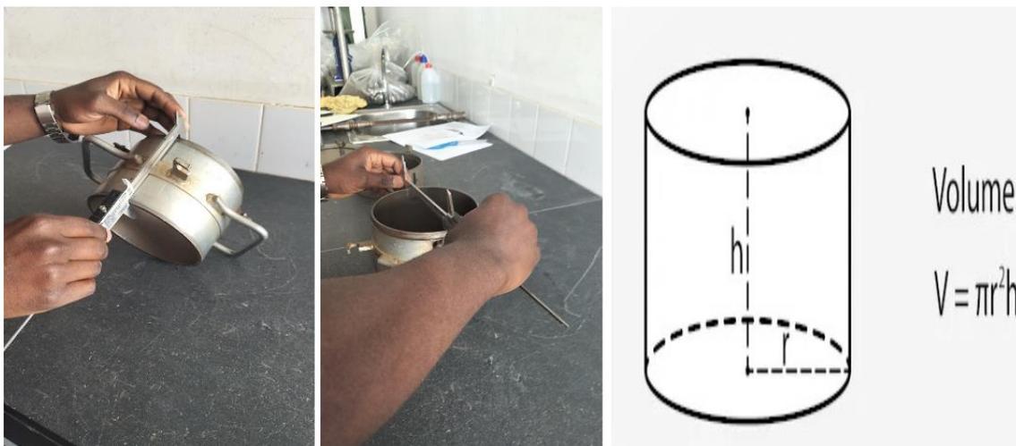
*Figura 21. Determinação do volume do molde*
