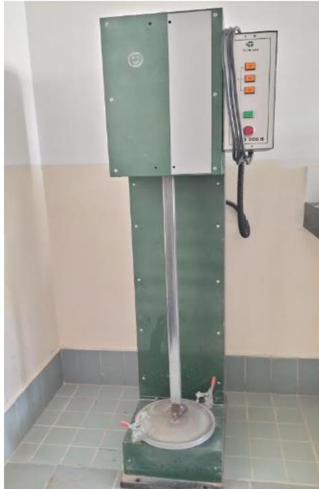
Figura 19. Compactador mecânico
