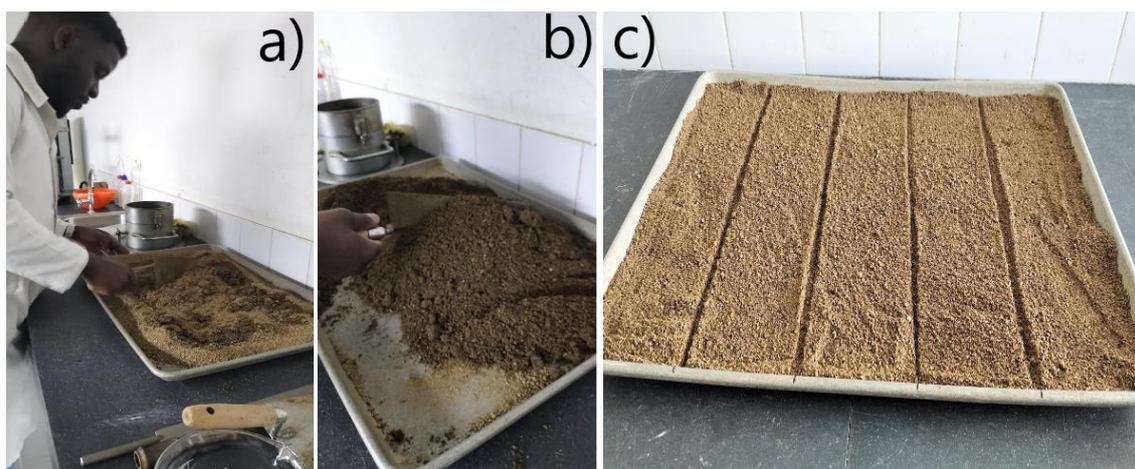
*Figura 24. Homogeneização e divisão do provete: a) homogeneização; b) provete homogeneizado; c) provete dividido em cinco porções, aproximadamente, iguais*
