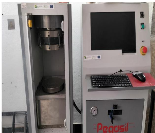
*Figura 31. Prensa usada para o carregamento dos provetes*
