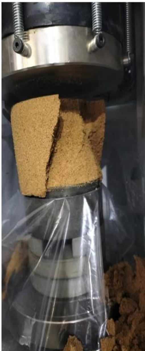
*Figura 49. Imagem de um provete de uma das amostras do conjunto Z destruído após o início do carregamento*
