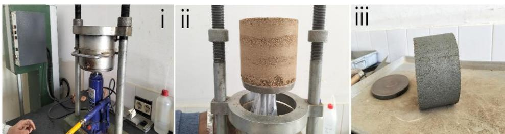
*Figura 29. Extração de um provete após compactação*
