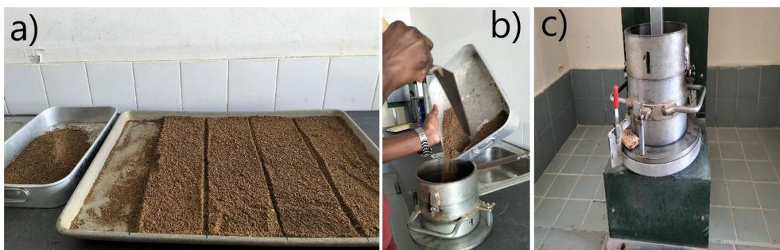
*Figura 25. Transferência e compactação da primeira parte: a) transferência do tabuleiro maior para o de menor; b) transferência do tabuleiro menor para o molde; c) molde preso à base do compactador*
