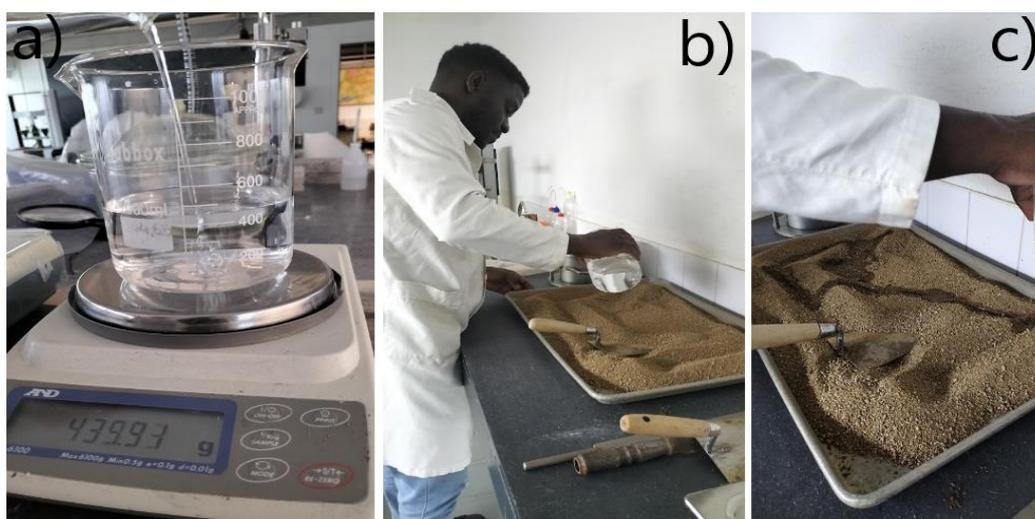
*Figura 23. Humedecimento de provetes: a) medição da água a adicionar; b) provete previamente colocado no tabuleiro e pronto a humedecer; c) humedecimento de provete*
