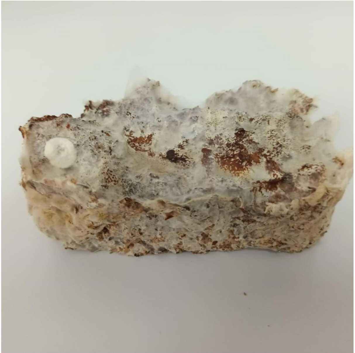
Figura 40 – Tijolo de cogumelo, feito de micélio e serradura , teste desenvolvido no laboratório de Macromicologia, da Universidade de Évora, Polo da Mitra, Évora, janeiro de 2022. Coleção da autora.
