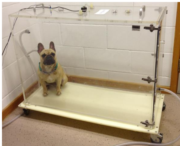
Figura 25 – Câmara usada para o teste de pletismografia barométrica de corpo inteiro. (Adaptado de Liu et al., 2015) 84
