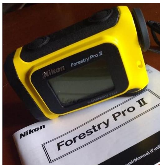
**Figura 8.** Aparelho medidor de distâncias, em metros.
