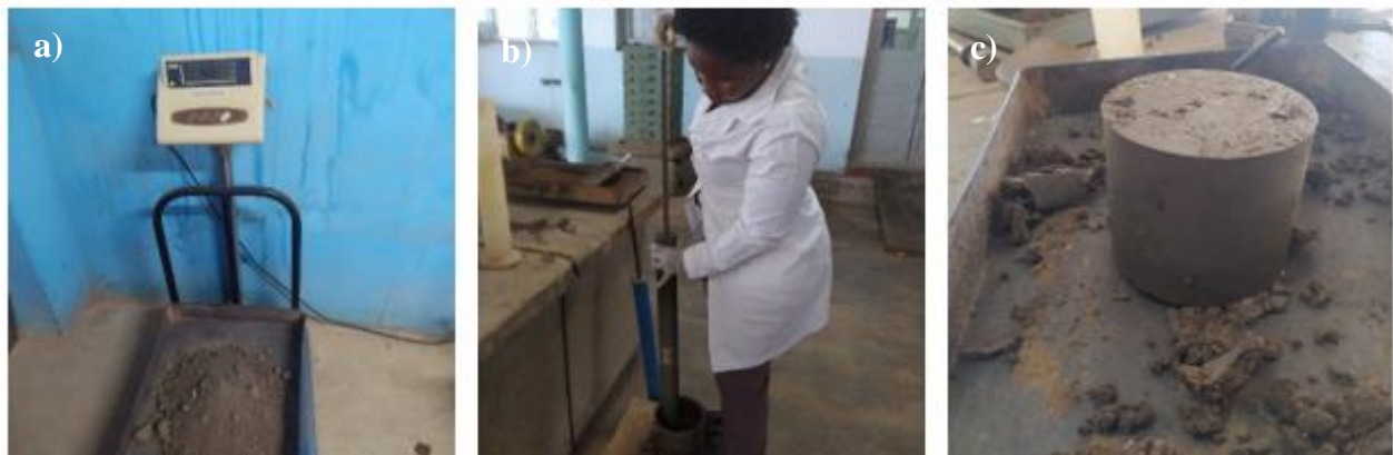
Figura 4-13: Ensaio de compactação do tipo proctor a) Pesagem do solo. b) Processo de compactação com o pilão pesado. d) Provete do solo retirado do molde.
