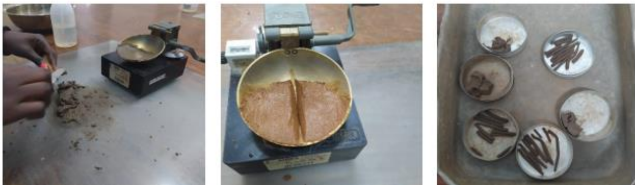
Figura 4-12: Realização do ensaio para determinação do limite de liquidez nos solos amostrados.
