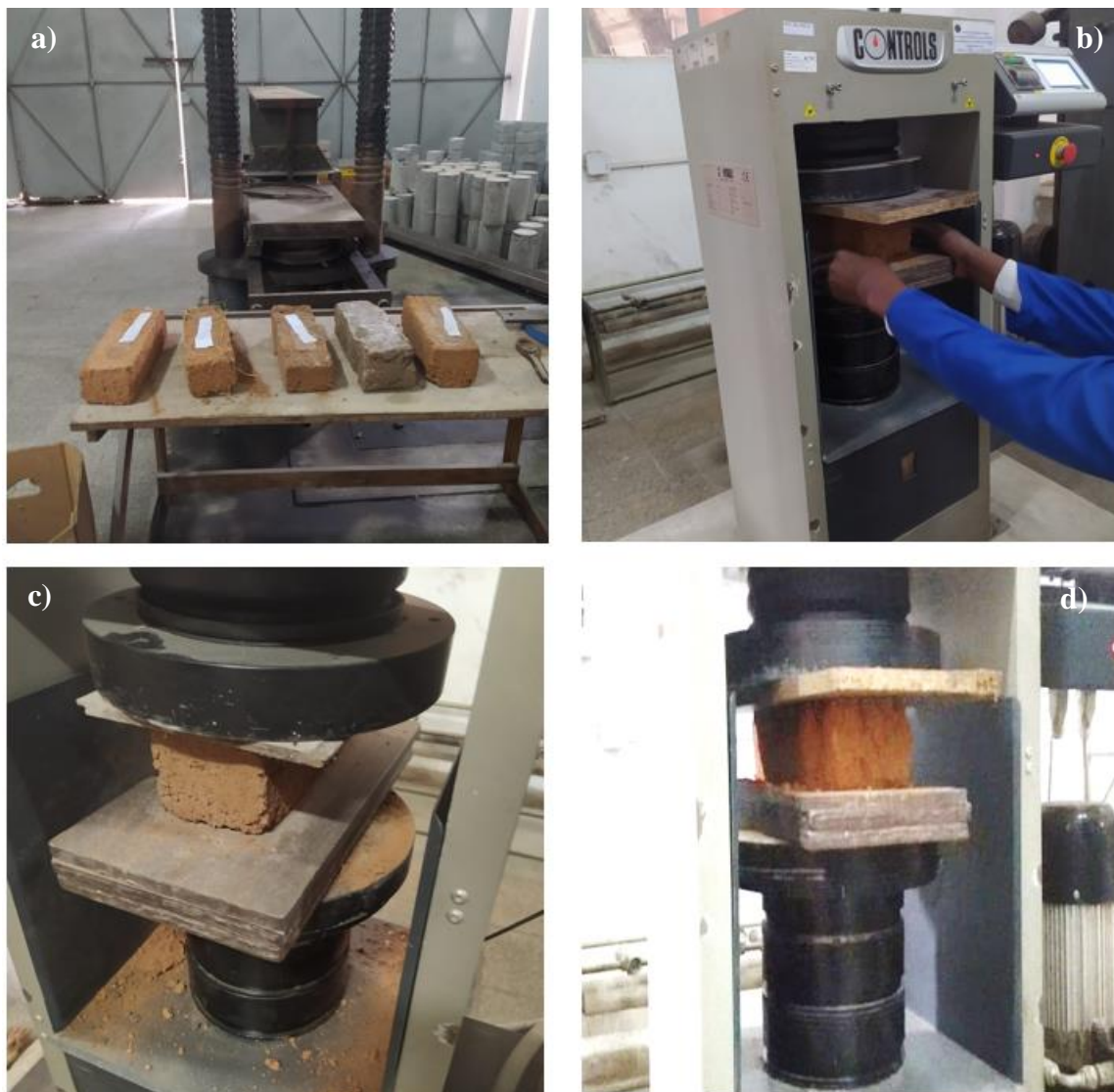
Figura 4-16: Realização do ensaio de resistência dos adobes: a) Preparação dos adobes para pesagem; b) Colocação do adobe na Prensa de Compressão Universal; c) Compressão uniaxial sobre o adobe; d) Rotura do adobe.
