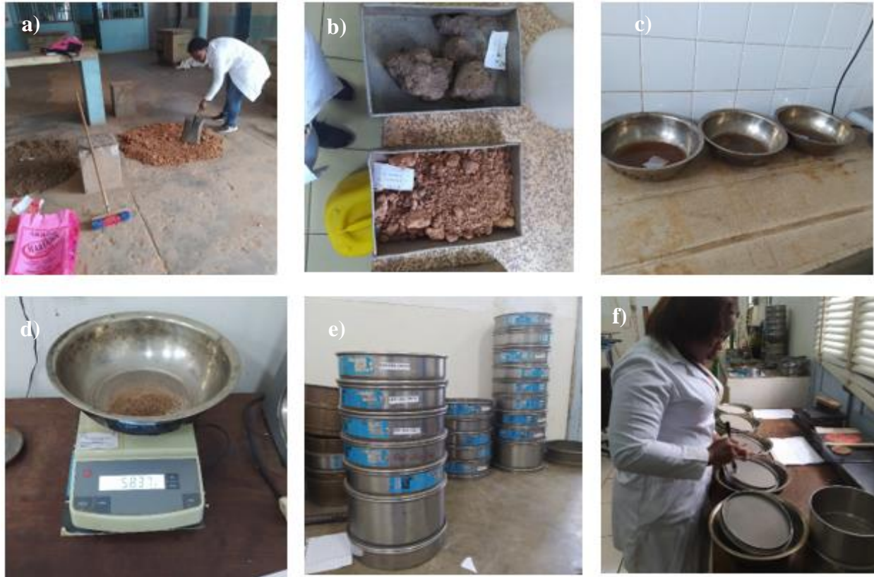
Figura 4-9: Processo de análise granulométrica por peneiração seca: a) Preparação da amostra para o ensaio. b) Primeira secagem das amostras na estufa a uma temperatura de 110 °C durante 24 horas. c) Imersão das amostras na água durante 24 horas. c) Pesagem das amostras após a lavagem e secagem na estufa. d) Série de peneiros utilizados para a peneiração das amostras de solo. f) Processo de separação do material retido nos peneiros para posterior pesagem.
