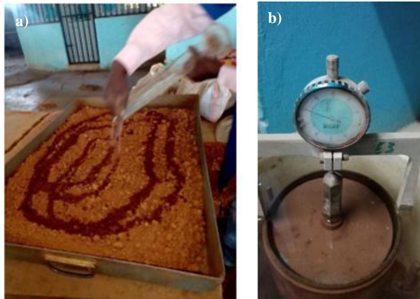
Figura 4-14: Ensaio de expansibilidade: a) Preparação da amostra para compactação; b) Leituras da expansibilidade com defletómetro.
