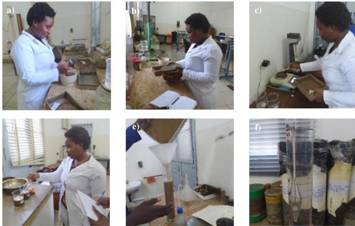
Figura 4-10: Processo de análise granulométrica por sedimentação: a) Preparação das amostras. b) Crivagem da amostra no peneiro n.º 10. c) Pesagem da amostra que passou do peneiro n.º 10. d) Homogeneização das amostras nos copos de pirex com a solução de hexametáfosfato de sódio. e) Coleta da água que passou do peneiro n.º 200 para a proveta de 1000 ml. f) Densímetro utilizado para o processo da leitura das densidades em intervalos de tempo diferentes.
