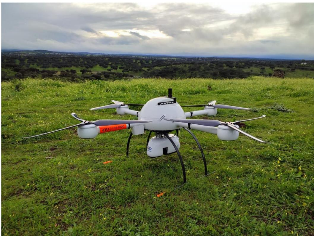
Figura 11 – Drone Microdrones md4-1000, utilizado no projecto *Odyssey*.
