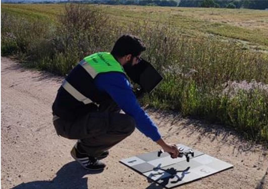
Figura 39 – Preparação de voo com *drone* multiespectral.
