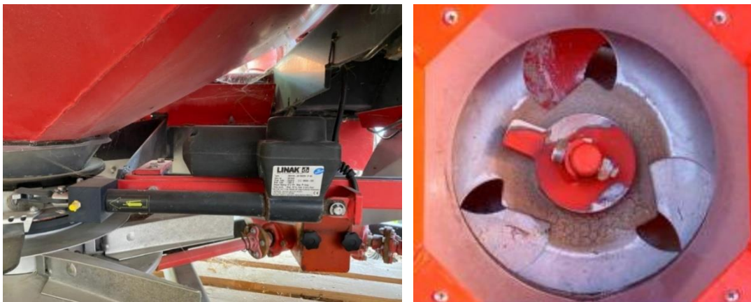
Figura 25 - Atuador linear LINAK (à esquerda) e janelas de regulação de caudal (à direita) no distribuidor “Vicon RS-EDW”.
