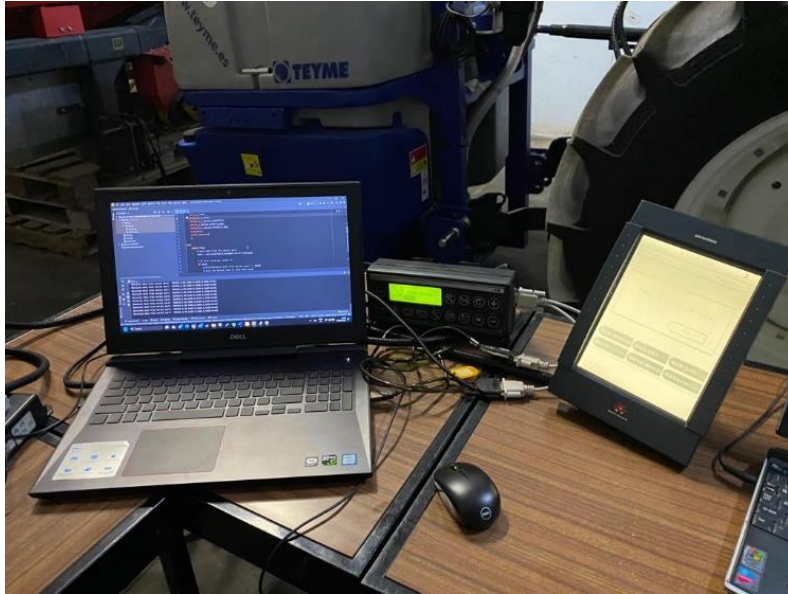
Figura 42 – Ligação entre o terminal “Fieldstar”, o computador e o “Ferticontrol”.
