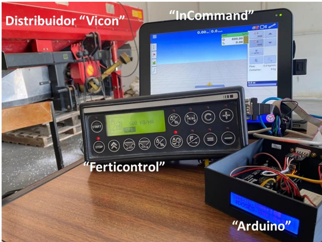
Figura 46 - Sistema desenvolvido em “Arduino” para comunicação entre o “InCommand” e o “Ferticontrol”.
