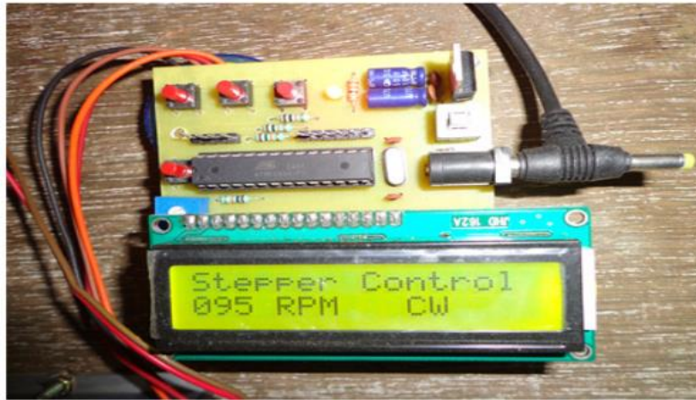
Figura 21 - Controlador principal e controlador do motor com LCD (Liquid Crystal Display), informativo do processo (Gurjar et al., 2017).
