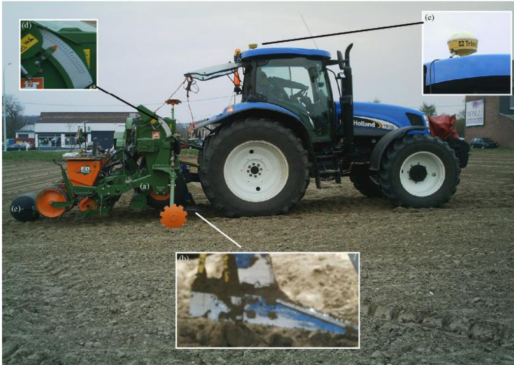
Figura 5 - Sistema de sensorização num distribuidor para aplicação de fertilizante em tempo real; (a) distribuidor “AMAZONE, ED302”; (b) sensor; (c) antena DGPS; (d) atuador elétrico; (e) rolo compactador para fechar o rego (Maleki et al., 2008).
