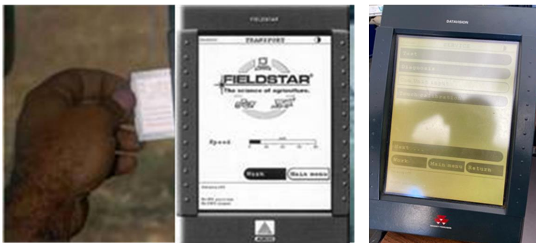
Figura 41 - Monitor “Fieldstar” da “Massey-Ferguson” e respetivo cartão de memória tipo “PCMCIA”.
