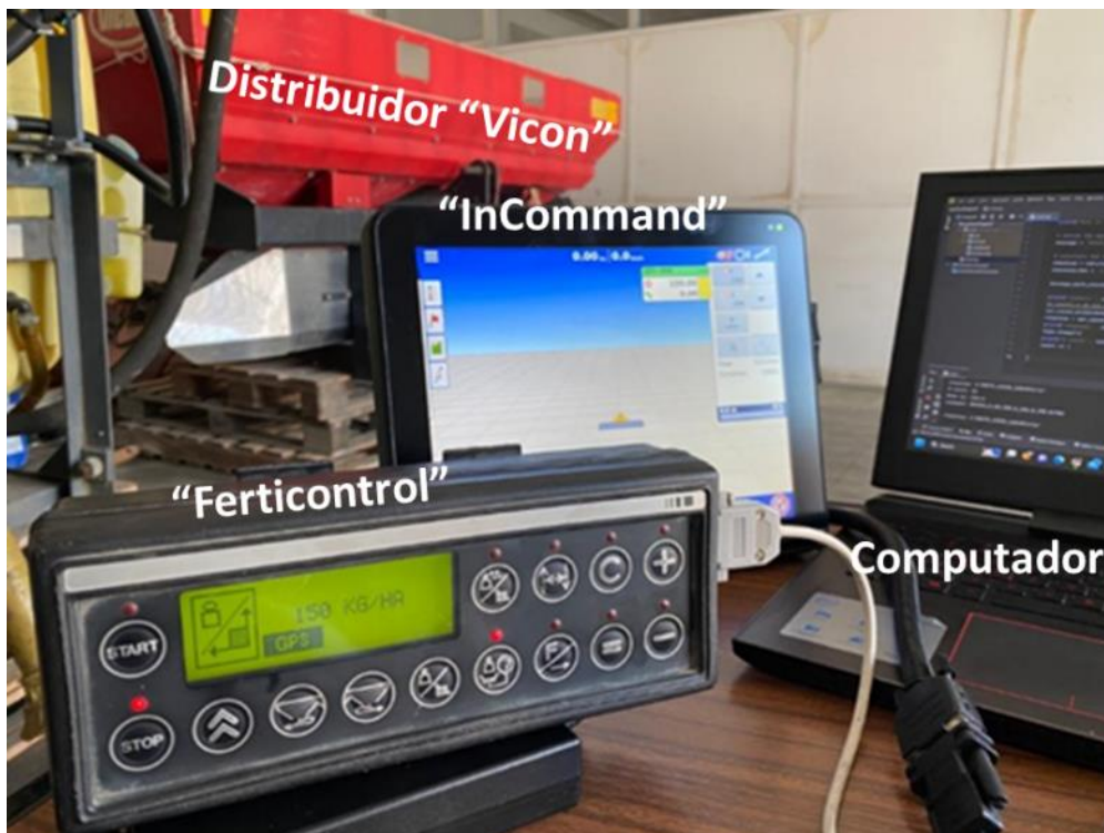
Figura 56 - Sistema de teste de comunicação entre o monitor "InCommand" e o "Ferticontrol", utilizando um computador como interface.
