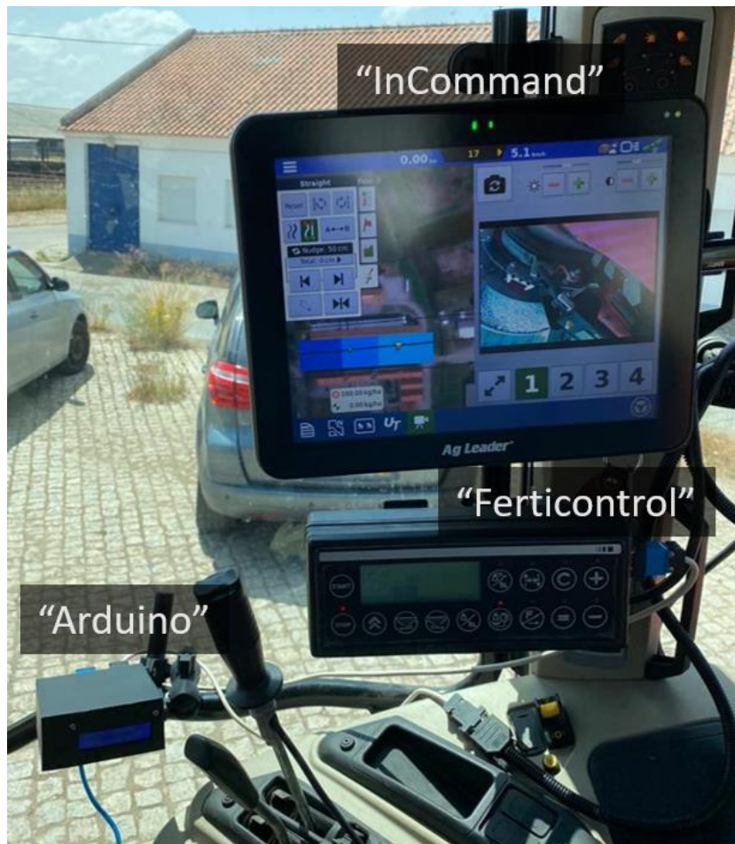
Figura 63 - Sistema “Direct Command”, “Arduino” e “Ferticontrol” instalados no trator.
