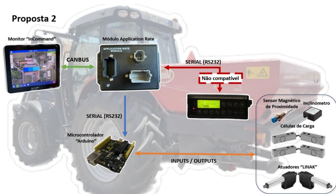
Figura 32 – Diagrama esquemático da proposta II.
