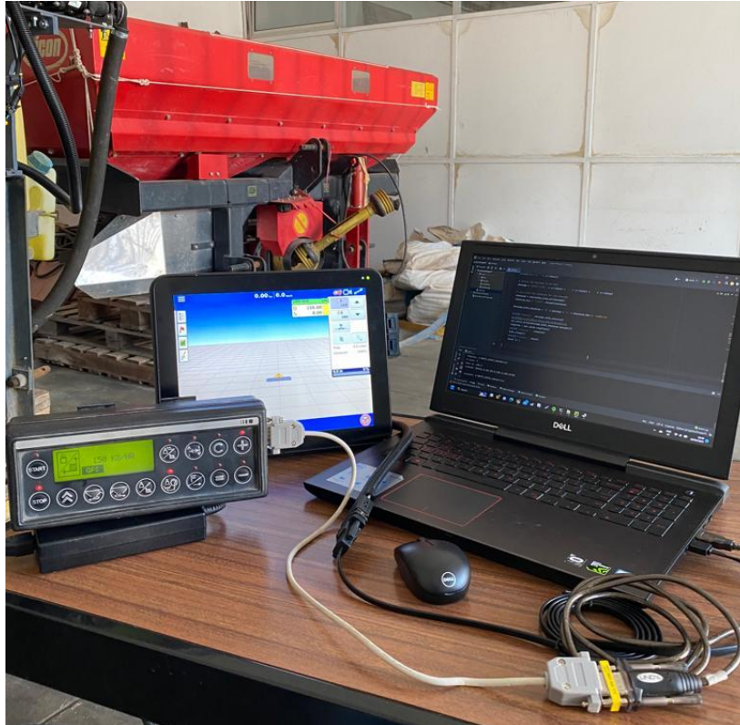
Figura 44 - Conexão entre o monitor “InCommand” e o “Ferticontrol” utilizando duas portas “RS232” e um algoritmo desenvolvido em “Python”.
