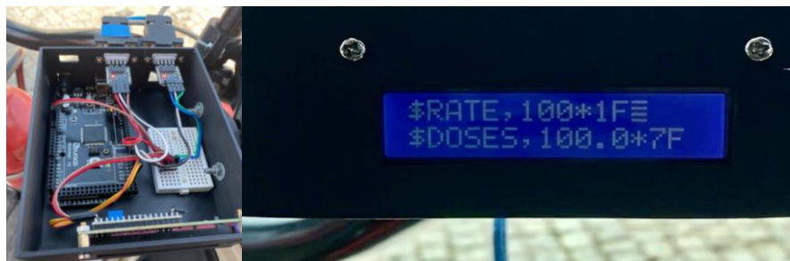
Figura 65 - Densidade de aplicação recebida e convertida pelo algoritmo do controlador "Arduino Mega"
