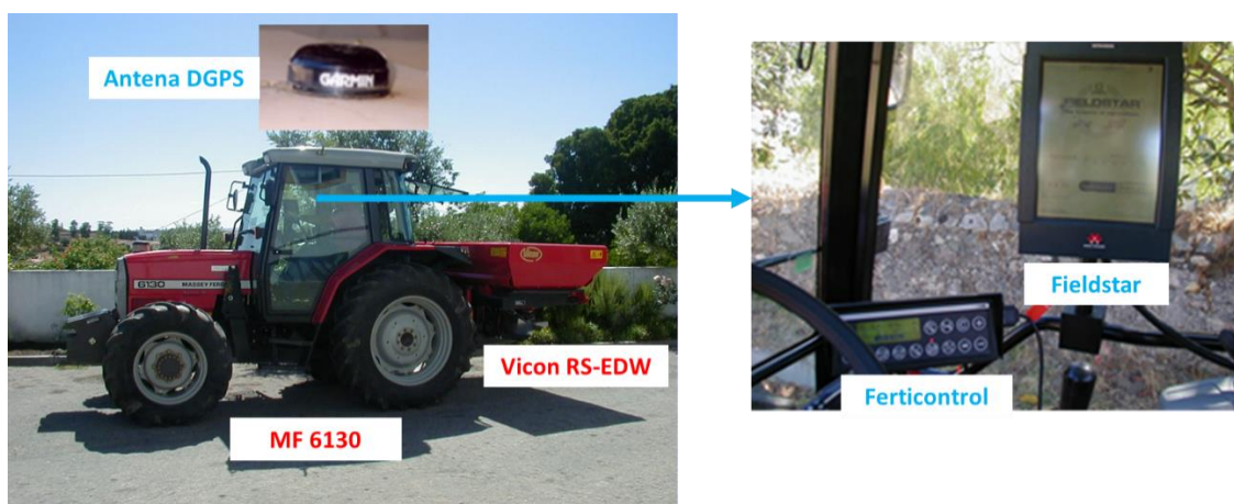
Figura 24 -Conjunto trator Massey-Ferguson 6130, distribuidor “Vicon RS-EDW”; pormenor da antena DGPS “Garmin 16” e dos controladores “Ferticontrol” e “Fieldstar”.
