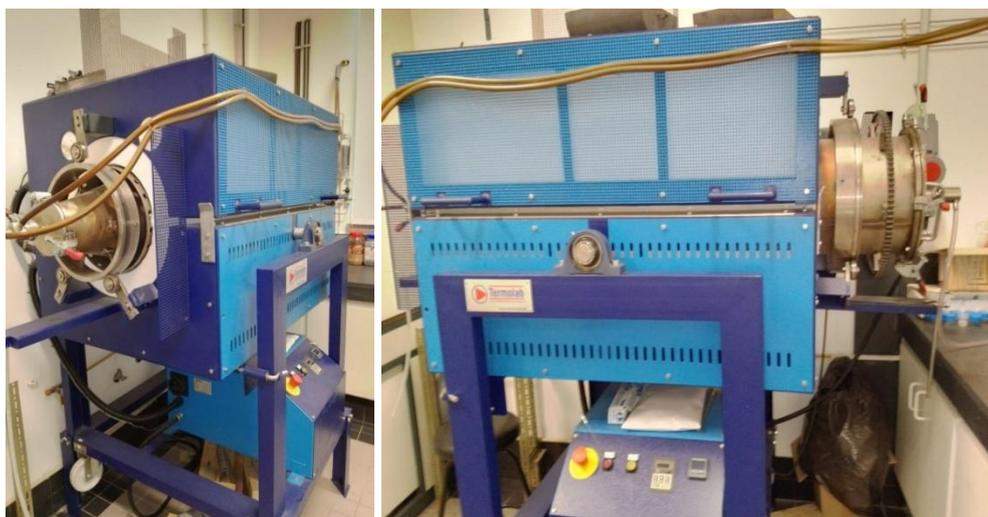
Figura 2.2 – Forno tubular horizontal da Thermolab. Equipamento usado para a produção de carvões ativados.
