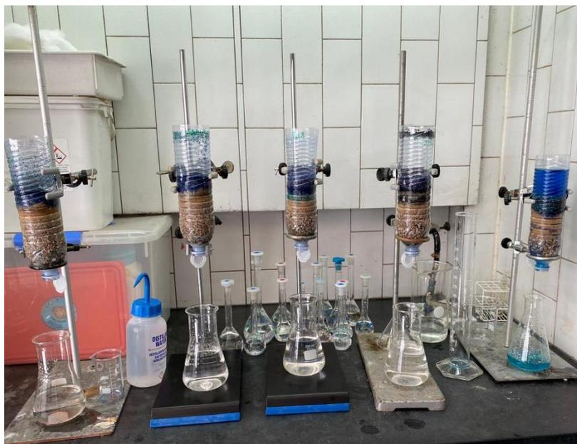
Figura 3.27 – Exemplo dos filtros de areia lenta usados durante o processo de remoção do MB da solução aquosa.
