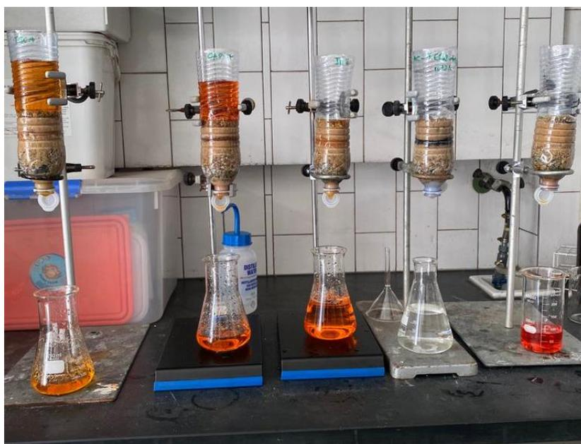
Figura 3.32 – Exemplo dos filtros de areia lenta usados durante o processo de remoção do MO da solução aquosa.
