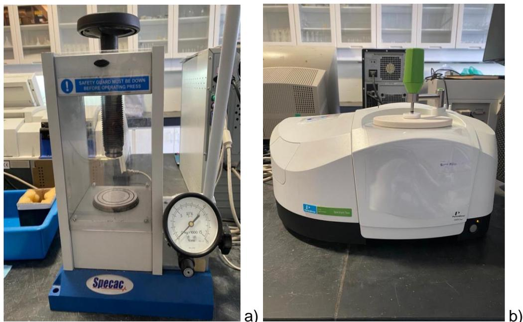
Figura 2.5 – Equipamento usado no FTIR: a) Prensa usada na preparação das pastilhas; b) Espectrofotómetro de infravermelho, em modo ATR.
