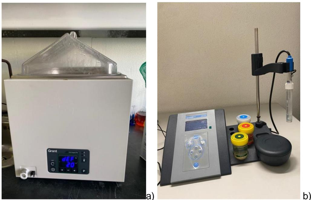
Figura 2.3 – a) Banho termostalizado, b) Potenciómetro de marca Nach.
