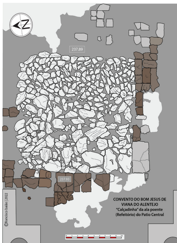
Figura 6.1 - Desenho da calçadinha da ala poente do Pátio Central, a ser desmontada. Desenho do autor.
