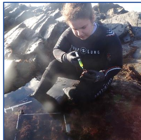
Figura 16 - Marcação química, com injeção de calceína (100 mg/L), in situ .
