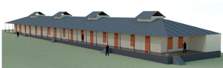
Figure 20 : « Blocs de logements – Gestionnaires ». Élément n° 8 du plan initial. Représentation 3D Composé de 4 unités de logement, de haut hierarchie. Elévation de la plante à 1,5 m au-dessus du sol Source: MEZA Mauricio, 2022
