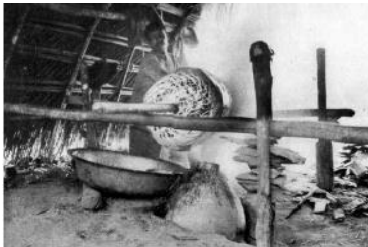
Figure 41 : Fumage du caoutchouc, procès technique pour emballer la resine et faciliter son transport. Source: CORDOBA, Lorena I., Dos suizos en la selva, 2015
