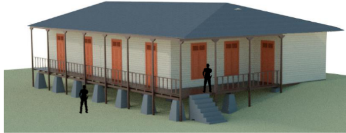
Figure 20 : « Blocs de logements – Gestionnaires ». Élément n° 8 du plan initial. Représentation 3D Composé de 4 unités de logement, de haut hierarchie. Elévation de la plante à 1,5 m au-dessus du sol Source: MEZA Mauricio, 2022
