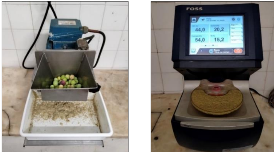
Figura 31. Máquinas de moer e analisar a pasta das azeitonas, respetivamente
