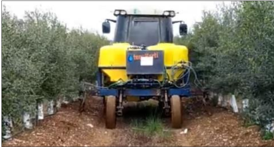
Figura 61. Máquina VRT de aplicar líquidos junto da linha de plantação
