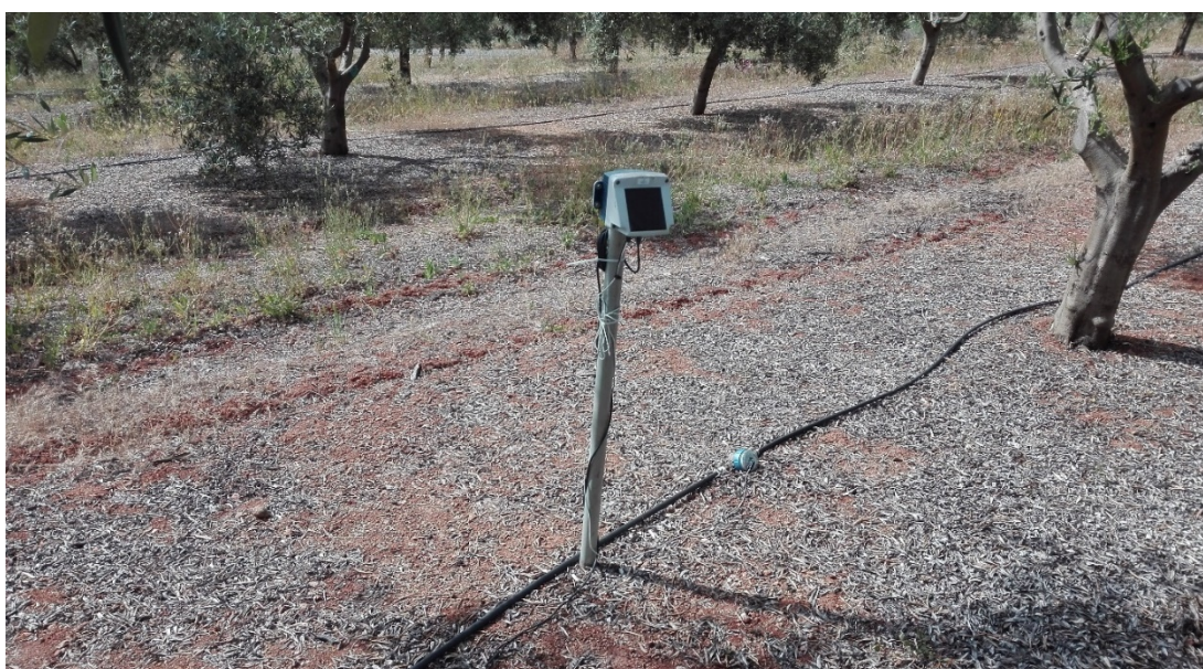
Figura 3.8 Sonda capacitiva para medição do teor de água a várias profundidades na parcela do olival.
