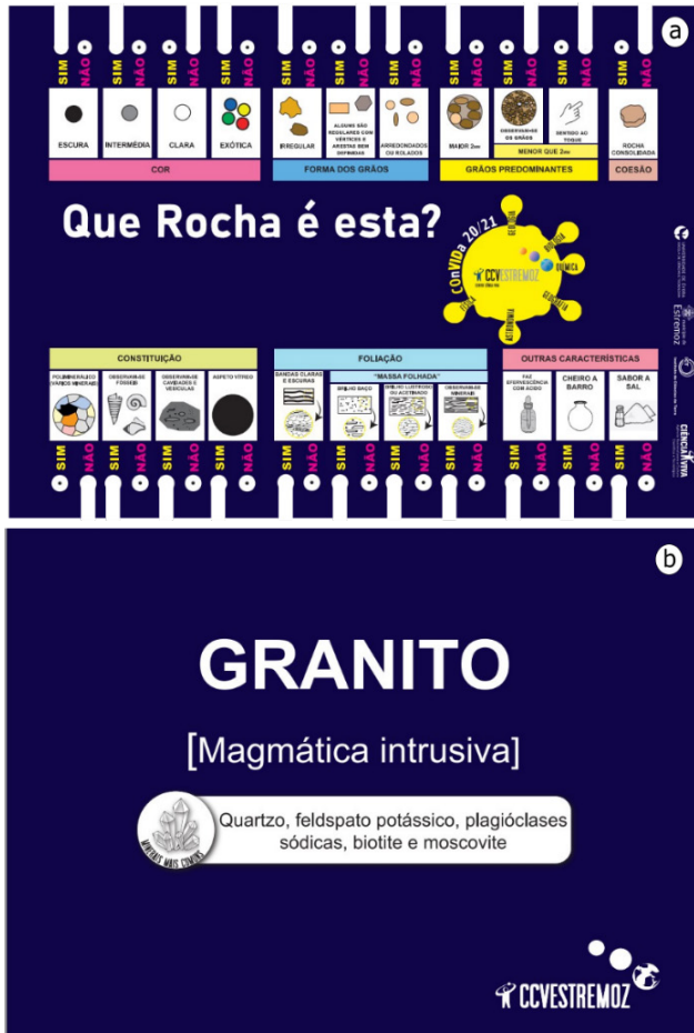
FIGURA 2. Uma carta da chave dicotômica, nomeadamente do granito, com a face dianteira (a) com as categorias que identificam a rocha com o furo fechado e categorias não identificativas a aberto e com a face de trás (b), com a identificação da rocha e a sua mineralogia
