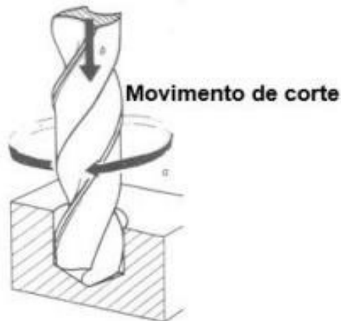
Figura 3-Movimento da ferramenta durante a furação [12]
