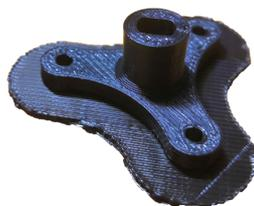
Figura 4.8: Componente obtido pela modelação por deposição de PLA
