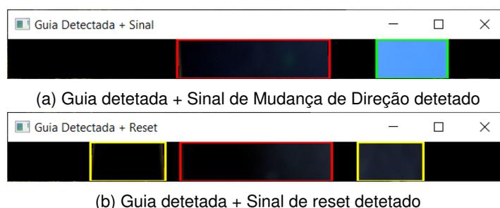
Figura 4.60: Elementos de interesse detetados devido à presença de guia
