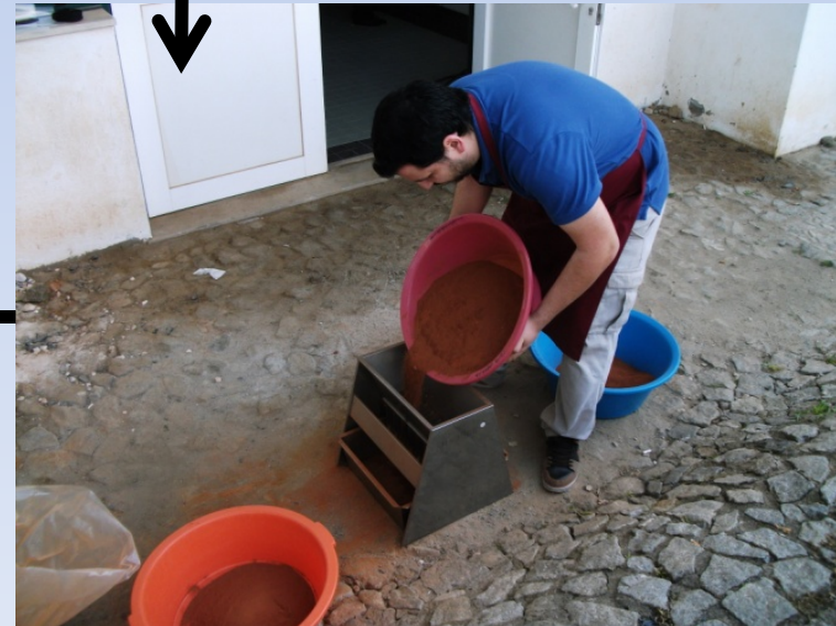
Partição das amostras com auxílio de um repartidor.
