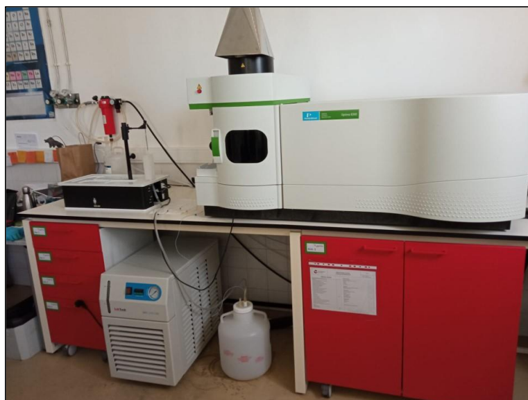
Figura 3. 4. ICP-OES Perkin-Elmer OPTIMA 8300 pertencente ao laboratório de Biogeoquímica Ambiental AmbiTerra, da Universidade de Évora.
