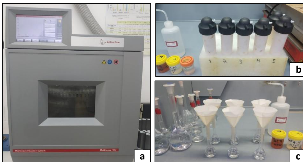
Figura 3. 5. Processo de digestão das águas ácidas da Mina de São Domingos para posterior análise em ICP-OES. a) Micro-ondas Anton Paar Multiwave PRO pertencente ao Laboratório AmbiTerra ; b) Liners com as amostras; c) Filtragem das amostras.
