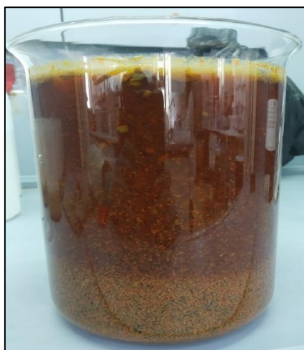
Figura 4. 16. Precipitação de metais presentes na solução devido ao aumento do pH.
