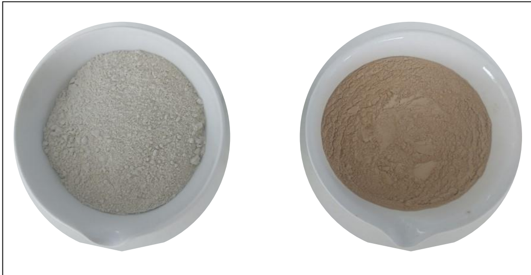
Figura 3. 14. Bentonita natural (esquerda) e após calcinação em mulfla a 500°C pelo período de 24 horas (direita).
