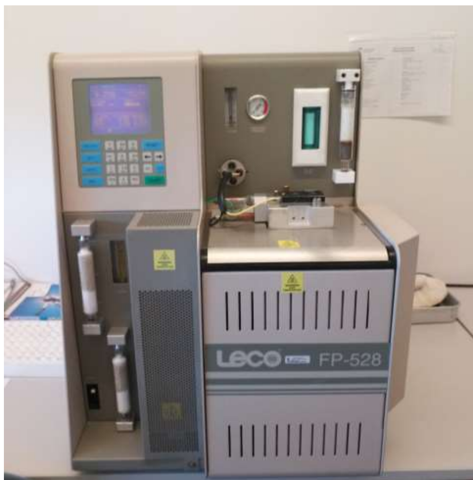
Figura 23: Determinação da Proteína Total – estimativa da percentagem de azoto total pela técnica de combustão de Dumas, com recurso ao aparelho Leco FP-528 (Fonte: autor)
