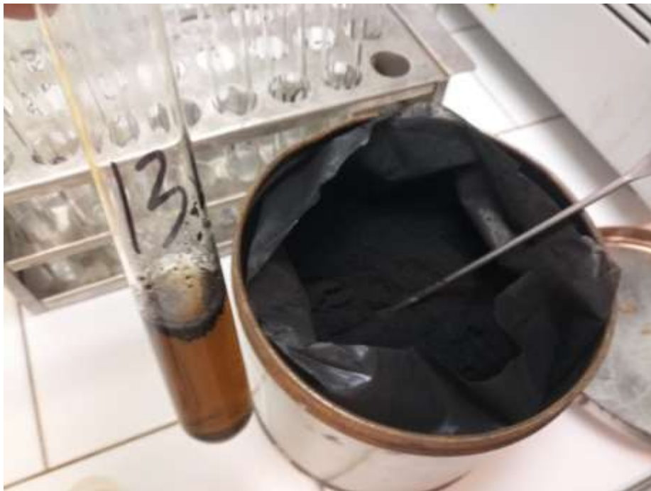
Figura 21: Determinação do colagénio total – adição de carbono ativado para posterior filtragem (Fonte: autor)
