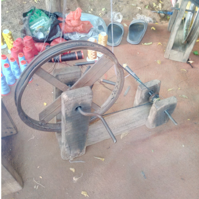
Figure 41 : Appareil de bobinage, Photo prise le 21/08/2019 à Fass par Abdoul Kader Faye.
