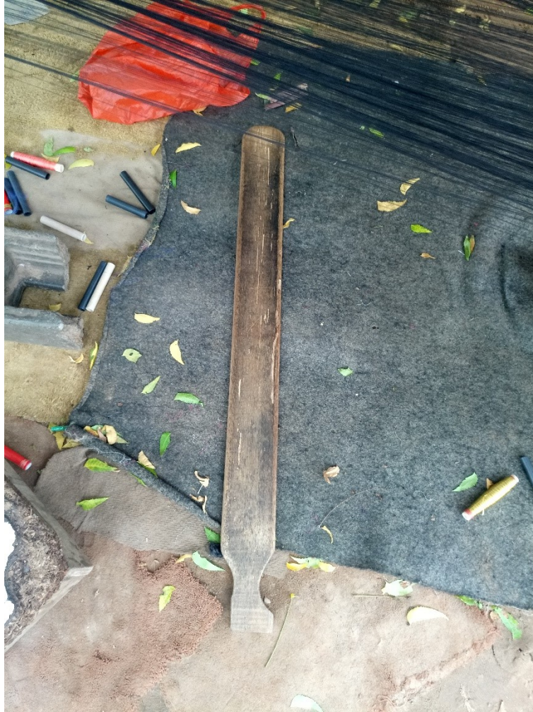
Figure 40 : Planche d'écartement des fils de chaîne, Photo prise le 23/08/2019 par Abdoul Kader Faye.
