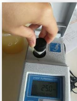
Fig 16. Turbidímetro (fotografia do autor)
