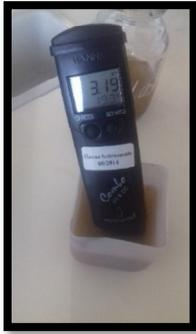
Fig 13. Potenciômetro de pH (fotografia do autor)
