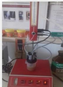
Fig 15. Ilustração da determinação do sulfuroso (fotografia do autor)
