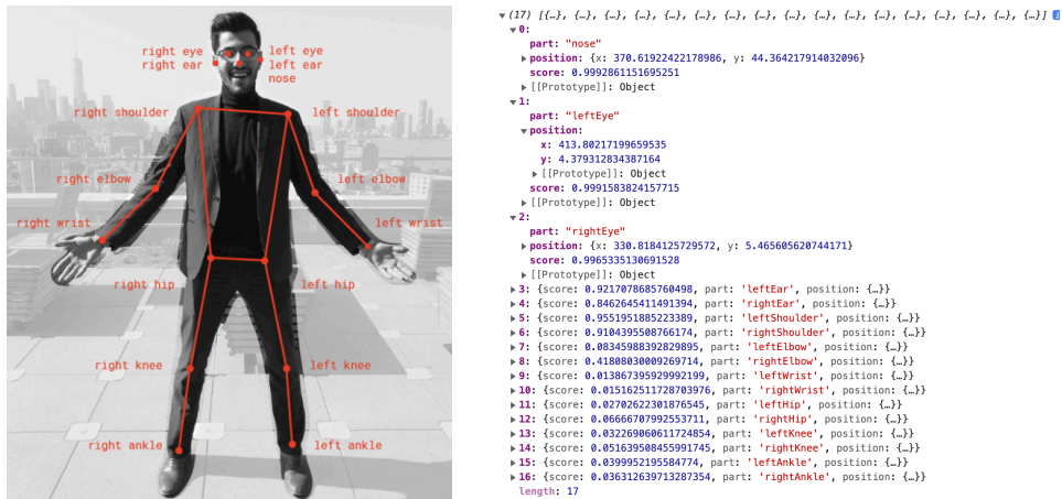
Figura 3.4: Vetor de 17 pontos-chave identificados pelo modelo PoseNet e respetiva legenda. Fonte: [key18]
