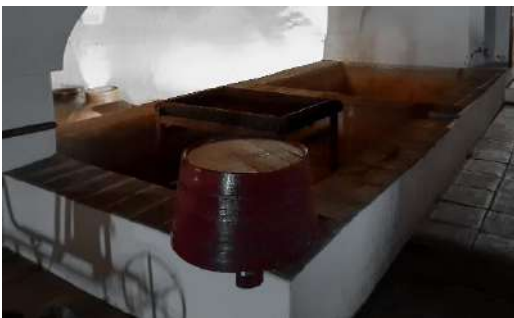
Fig. 62 - Lagares de betão e mesa de ripaço. (Foto do autor. 17 de outubro, 2019).
