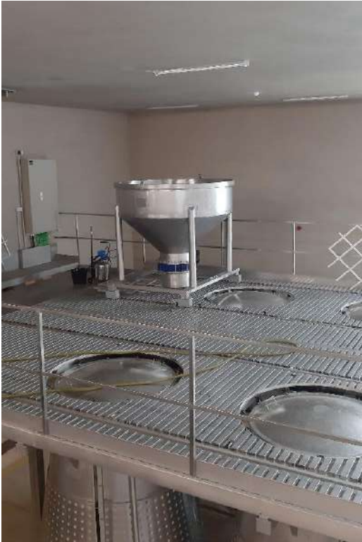
Fig. 197 - Instrumento que recebe a uva do piso 0 e a deposita nas cubas abaixo. (Foto do autor. 26 de setembro, 2019).
