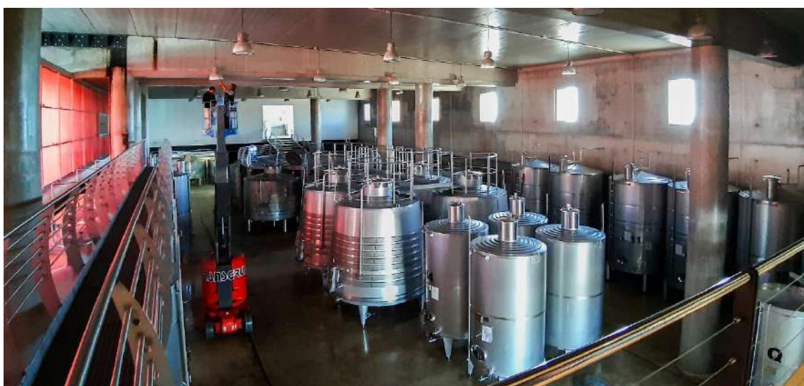
Fig. 90 - Sala de fermentação em cubas de inox. (Foto do autor. 25 de outubro, 2019).
