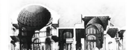
fig.005 | Corte Longitudinal das Termas de Caracalla
