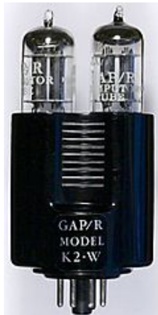
Figura 2.10: K2-W: AmpOp com válvulas (1953)
