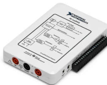
Figura 5.4: Placa de aquisição de sinal, texas instrumental myDAQ
