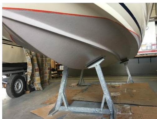
Figura 3.49: Serviço antivegetativo da obra viva da embarcação Rinker 182 finalizado
