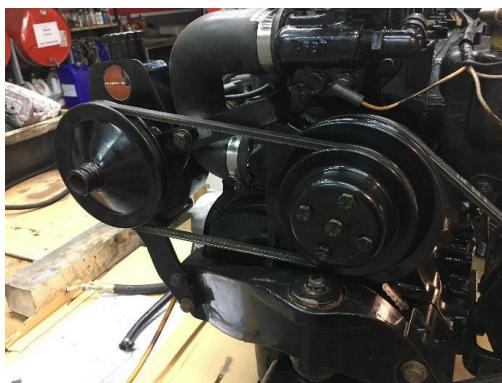
Figura 3.26: Correias da polia da bomba de circulação de água salgada no bloco e da polia da bomba de óleo da direção montadas
