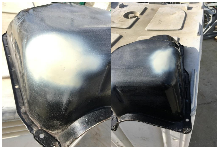
Figura 3.11: Cárter do motor após tratamento de corrosão
