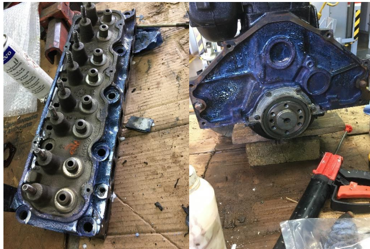
Figura 3.8: Tratamento de corrosão em zonas da colaça e bloco do motor
