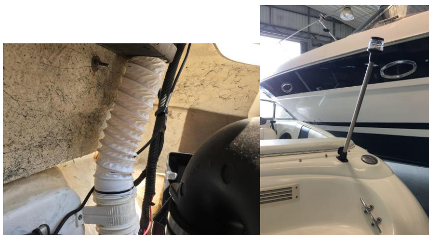
Figura 3.47: Novo exaustor de gases e nova luz branca de navegação 360°
