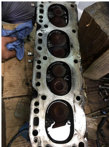
Figura 3.7: Teste de fuga às válvulas e cedex da colaça
