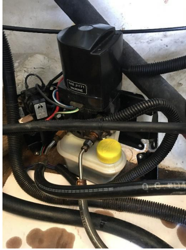
Figura 3.40: bomba de óleo do trim do espelho de popa
