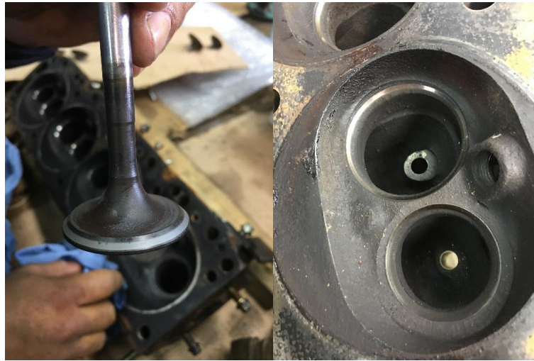
Figura 3.4: Válvula e sedes após o processo de rodar válvulas
