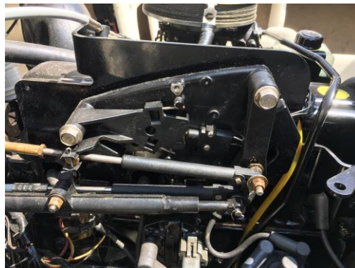
Figura 3.45: Suporte dos cabos de comando da transmissão do bloco do motor
