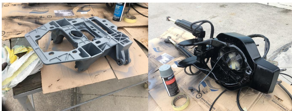
Figura 3.29: Pintura do espelho de popa e do seu suporte
