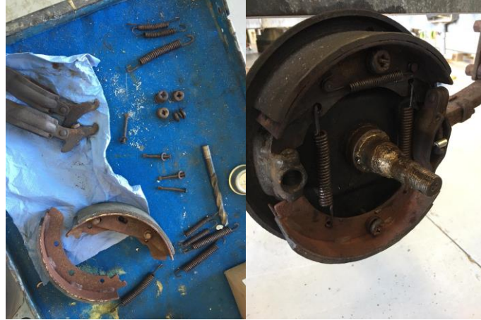
Figura 3.56: Montagem dos travões de tambor da polia da roda esquerda do reboque Monteiro e Marques 600
