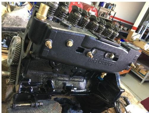
Figura 3.14: Novo coletor de admissão/escape montado no bloco do motor
