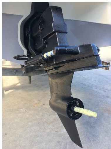
Figura 3.43: Pintura antivegetativa da transmissão
