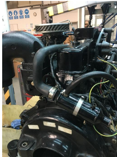
Figura 3.27: Refrigerador de óleo da direção montado no bloco do motor
