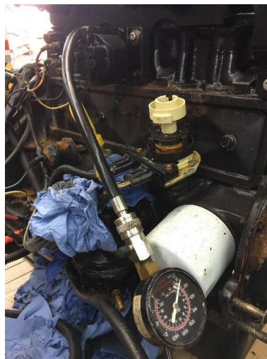
Figura 2.9: Teste de compressão ao motor com um medidor de pressão
