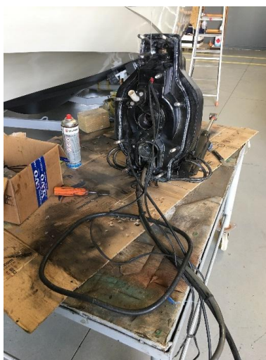
Figura 3.31: Colocação da junta do espelho de popa
