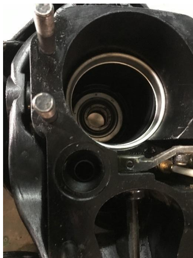
Figura 3.30: Fole da transmissão e retentor do rolamento montados no espelho de popa
