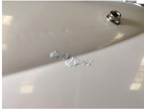
Figura 3.50: Aplicação da mistura gel coat numa das falhas de gel coat exterior da embarcação Rinker 182
