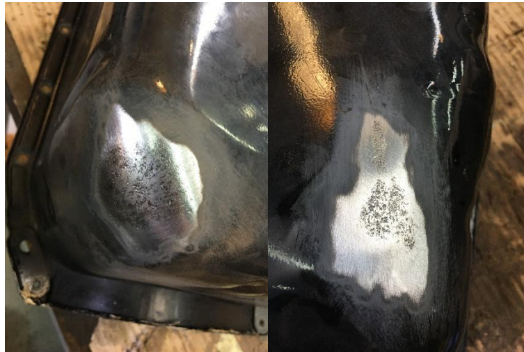
Figura 2.11: Zonas de corrosão no cárter do motor
