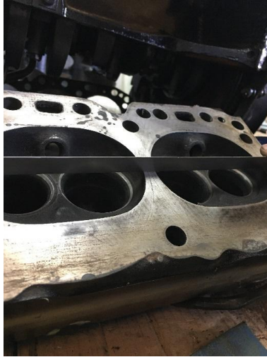
Figura 3.6: Verificação de empeno na face da colaça do motor
