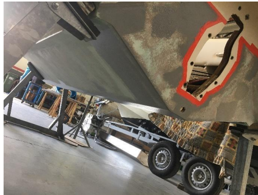
Figura 3.48: Obra viva da embarcação Rinker 182 regularizada com betume e primário epóxico
