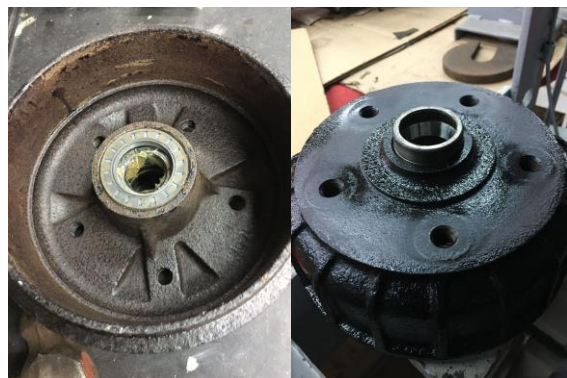
Figura 3.55: Tambor da roda direita do reboque Monteiro e Marques 600 com os novos rolamentos cónicos e pintado
