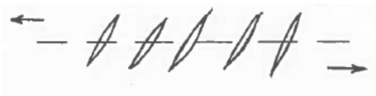
Figura 19 - Ao aplicar uma compressão horizontal numa das metades da tina, surgem pequenas fraturas, denominadas fendas de tração.
