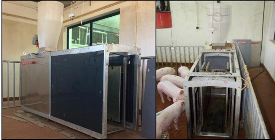
Figura 12 - Máquina de alimentação Schauer Compident MLP II (Fonte: elaboração própria)
