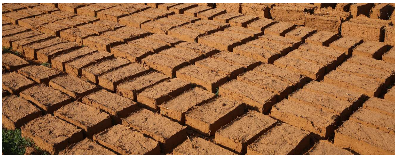
Fig. B-5 : Le séchage des briques d'adobe du kiosque à musique de Taanayel Source : Houda Kassatly
