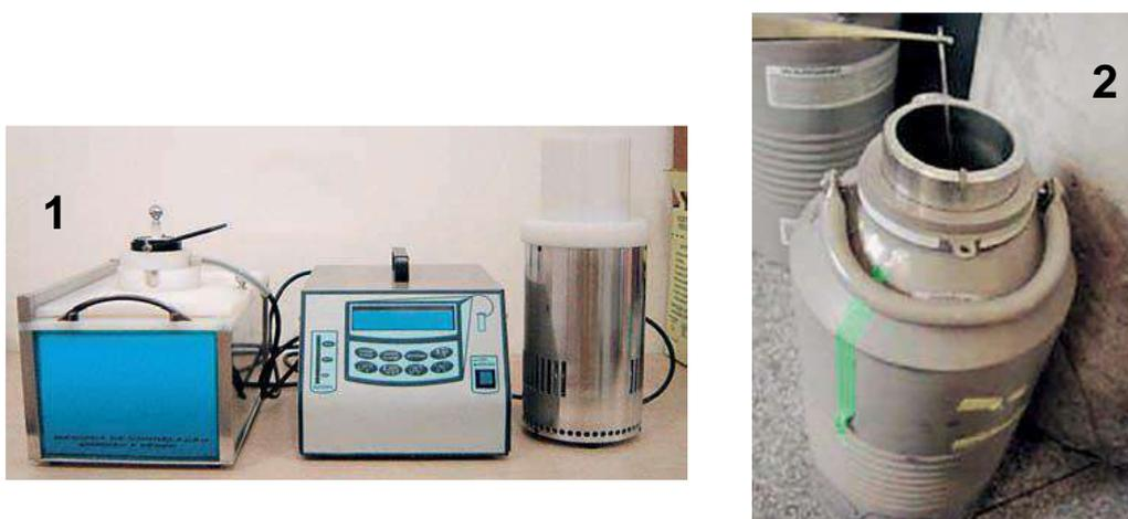
**Figura 8:** (1) Máquina para congelamento de sémen. (2) Congelamento de sémen usando o “dry shipper”; Fonte: Moreira & Morato, 2007
