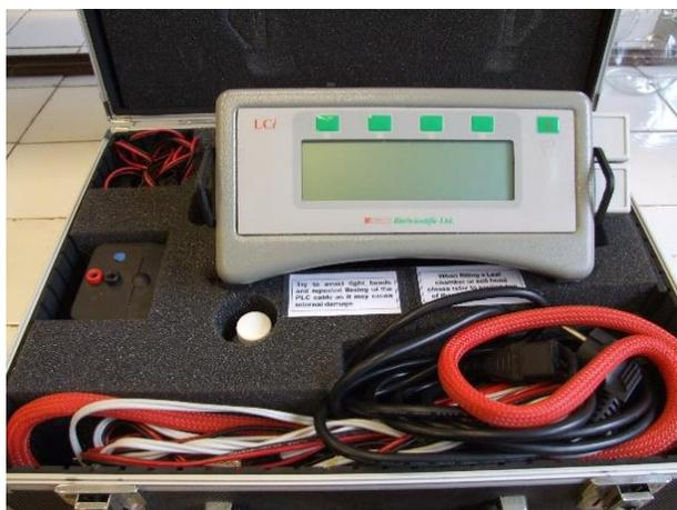
Figura 24 - Medidor de fotossíntese portátil LCI (Alsina, n.d.).
