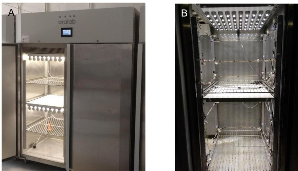
Figura 14 - Câmara de crescimento de plantas Fitoclima 1200 PHL (ARALAB). A - Exterior, equipada com iluminação fluorescente, B- Interior, equipada com iluminação LED, sensores de temperatura e sensores de humidade.
